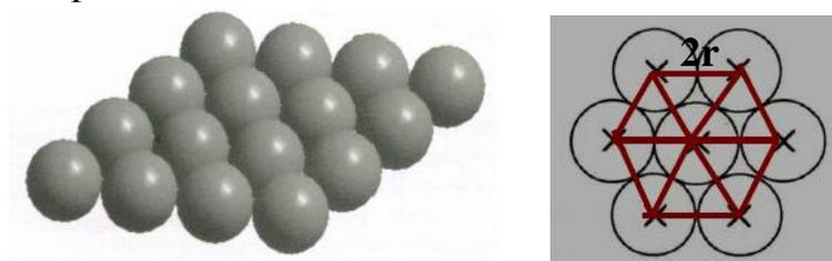
Figure II-4- Assemblage compact de sphères identiques dans un même plan
