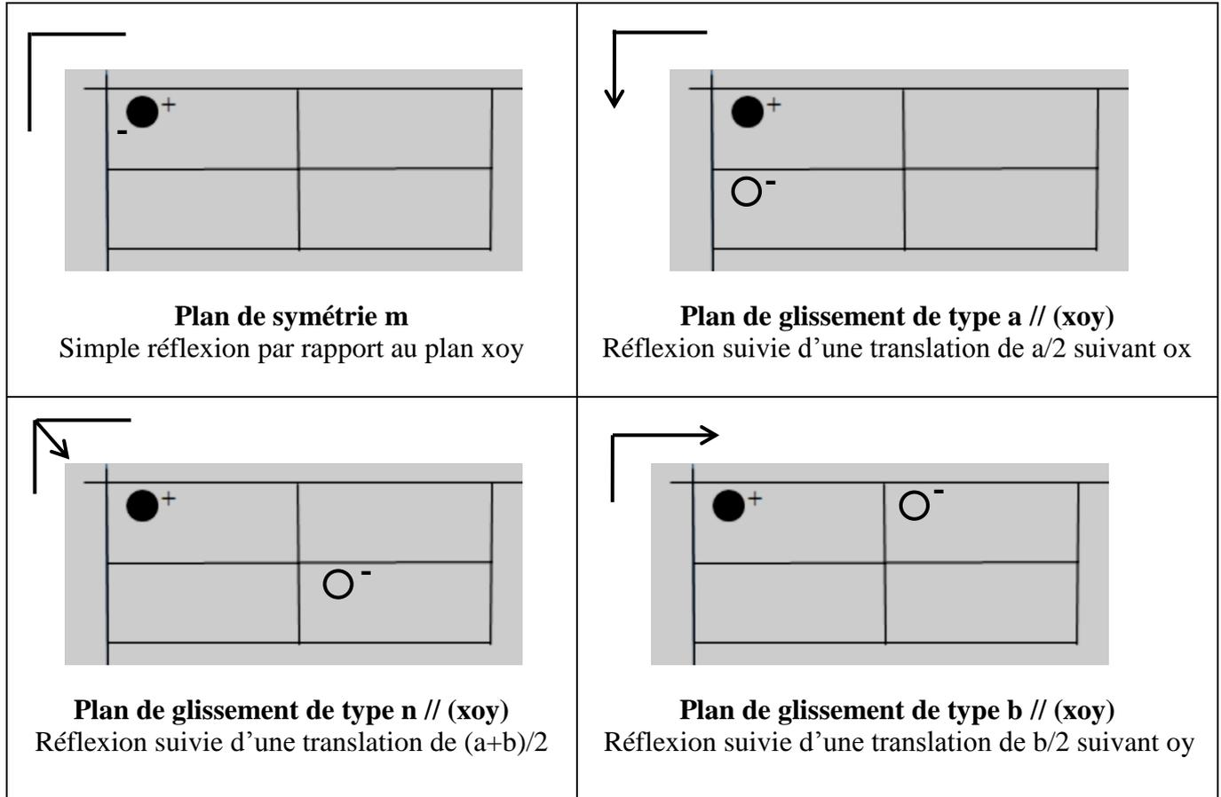
Si on considère un cristal à l'échelle macroscopique (ordre à grande distance), cad sans tenir compte de la répartition des atomes, la symétrie des cristaux se ramène à celle d'un polyèdre ne possédant, comme seuls éléments de symétrie potentiels, que les éléments d'orientation: 1, 2, 3, 4,  $\bar{6}$ , 1 et m. L'association de ces divers éléments conduit aux 7 systèmes cristallins, chacun d'eux étant caractérisés par un polyèdre de référence et par un degré de symétrie donné.
