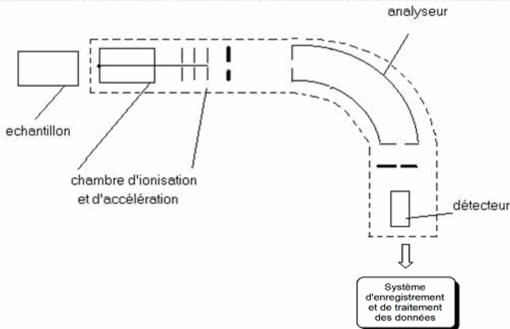
**Le système d'introduction** qui fait pénétrer l'échantillon dans le spectromètre.
