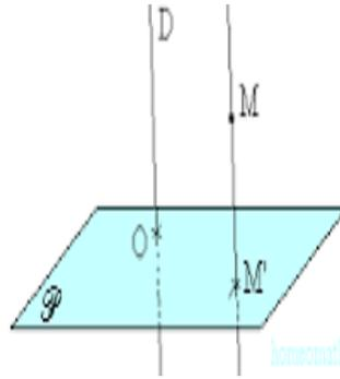
FIGURE 17. Projection sur  $\mathcal{P}$  parallèlement à  $D$
