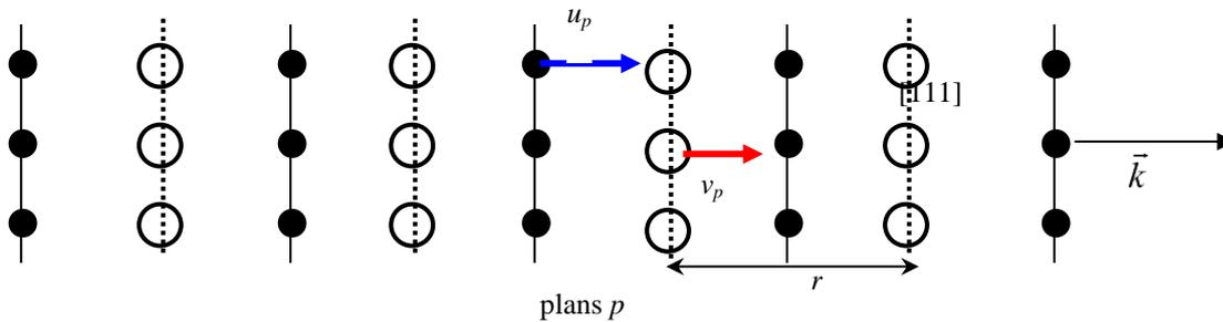
On suppose que chaque plan  $n$  n'interagit qu'avec ses deux plans adjacents, en appliquant la deuxième loi de Newton à chacun des plans  $p$  on obtient :
