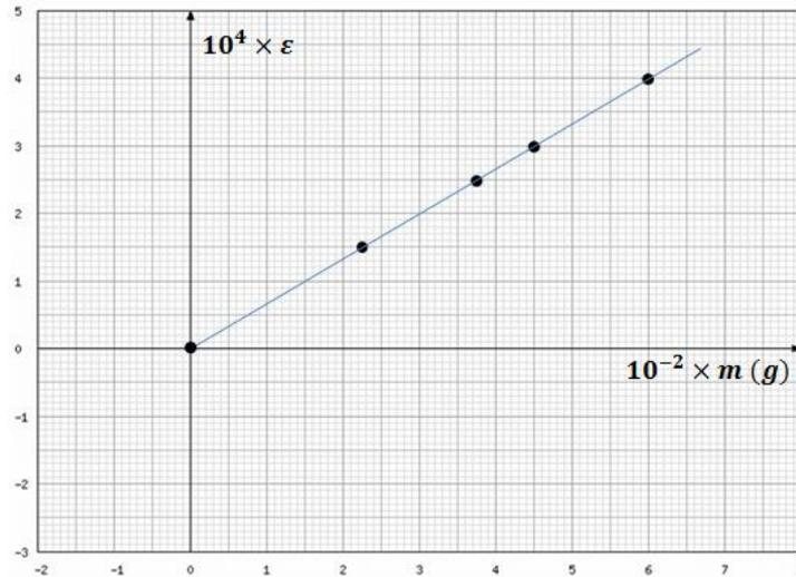
La courbe est une droite passant par l'origine. La masse  $m$  et la déformation  $\varepsilon$  sont proportionnels. Le fil s'allonge sous l'influence des forces appliquées par la masse. Il reprend sa forme initiale après que les forces cessent d'agir. C'est le domaine d'élasticité.
