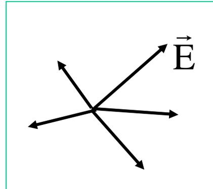
La configuration du vecteur vibrant à l'instant  $t + \Delta t$  est complètement différente de celle de l'instant  $t$ . Ce changement est lié au caractère totalement aléatoire de l'émission lumineuse.
