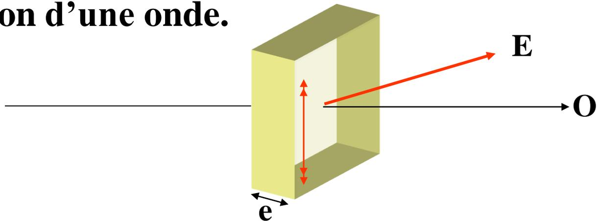
**Deux ondes de même fréquence polarisées suivant  $Ox$  et  $Oy$ , à la sortie de lame, subissent le déphasage :**
