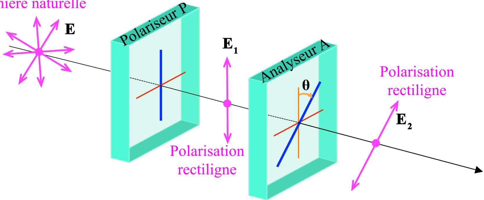
Si le champ ayant traversé **P** a pour amplitude  $\mathbf{E}_1$ , le champ traversant **A** est, à un facteur près, la projection de  $\vec{\mathbf{E}}_1$  sur la direction de polarisation de **A** :
