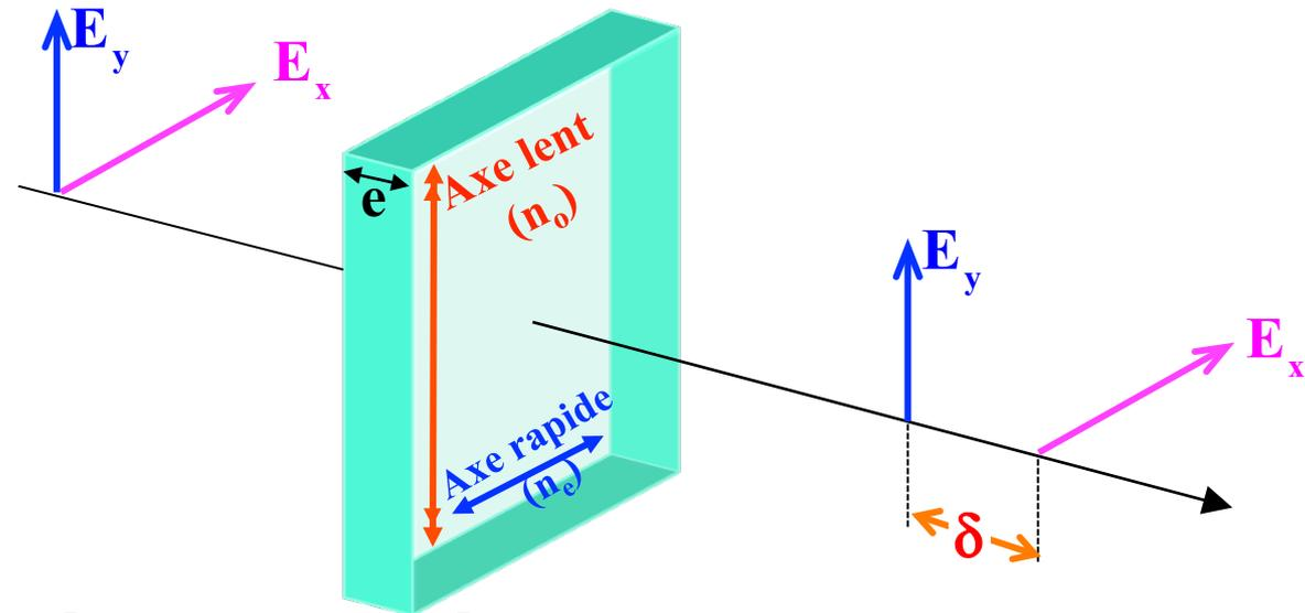
Pour une lumière polarisée rectilignement qui traverse la lame d'épaisseur  $e$ , la composante de la vibration incidente suivant l'axe lent subit un retard de phase par rapport à la composante suivant l'axe rapide.
