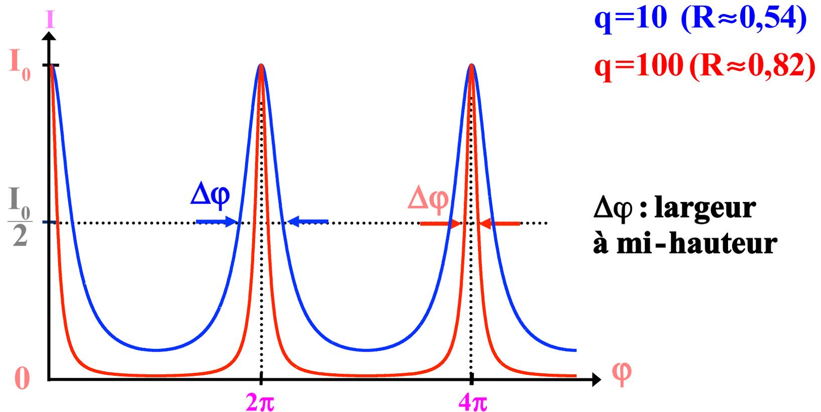
Lorsque  $R$  augmente, la largeur à mi-hauteur et l'intensité minimale diminuent.
