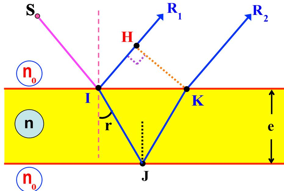
La différence de chemin optique entre les deux ondes qui interfèrent provient de la différence entre le chemin parcouru dans le verre par le faisceau 2 ( $IJK$ ) et la distance ( $IH$ ) dans l'air parcourue par le faisceau 1.
