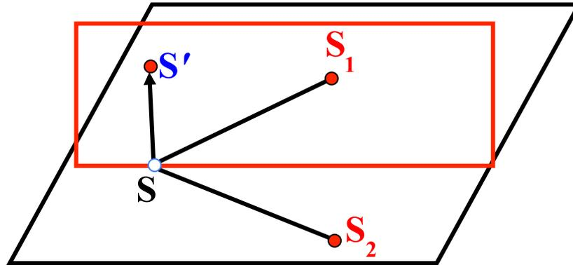
L'extension spatiale de la source selon  $Y$  n'introduit aucune différence de marche supplémentaire au niveau des trous, et donc entraîne la superposition des diverses figures d'interférences en coïncidence. On utilise donc cette extension pour obtenir plus de lumière sans perte de contraste.
