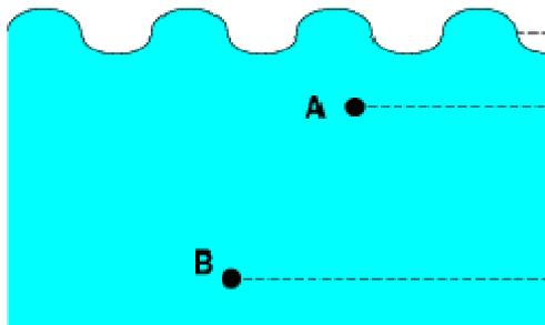
On choisit l'origine des altitudes à la surface de l'océan. Le point A correspondant à une profondeur de 15 m aura donc une altitude négative  $z_A = -15$  m. De même,  $z_B = -200$  m. On aura de plus :
