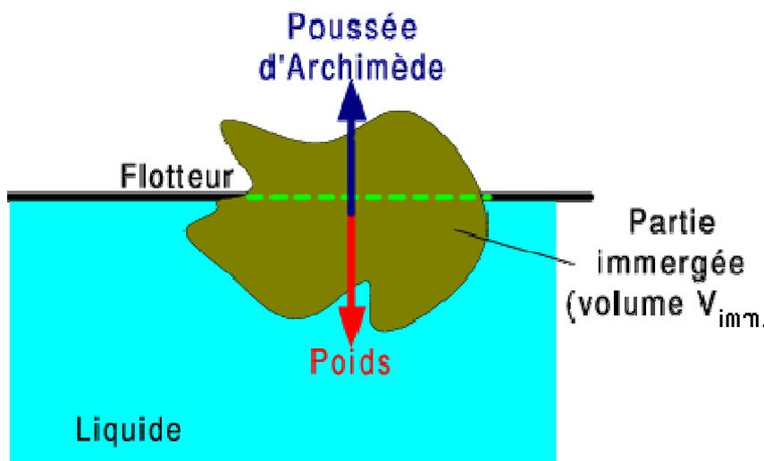
Tout d'abord, le flotteur est soumis à son propre poids, dirigé vers le bas et d'intensité  $m \cdot g$ , où  $m$  est la masse du flotteur et  $g$  l'accélération de la pesanteur.
