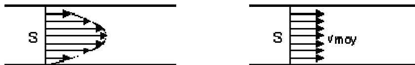
En général, la vitesse  $v$  n'est pas constante sur la section  $S$  d'un tube de courant ; on dit qu'il existe un **profil de vitesse** (à cause des forces de frottement). Le débit-masse ou le débit-volume s'obtient en intégrant la relation précédente :
