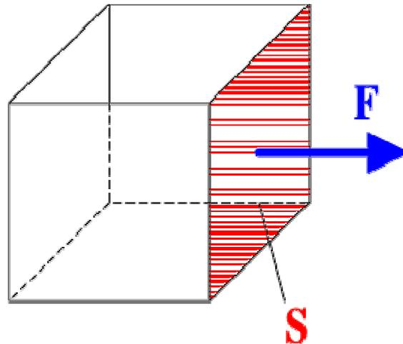
Considérons la figure ci-dessus représentant une enceinte contenant un fluide. Ce fluide exerce donc des forces sur chacune des parois. Ces forces sont dirigées vers l'extérieur de l'enceinte et sont perpendiculaires aux parois. Si on considère la face hachurée de surface  $S$ , le fluide lui applique une force  $F$ . On peut ainsi définir la pression  $P$  du fluide comme le rapport de cette force  $F$  et de la surface  $S$  :
