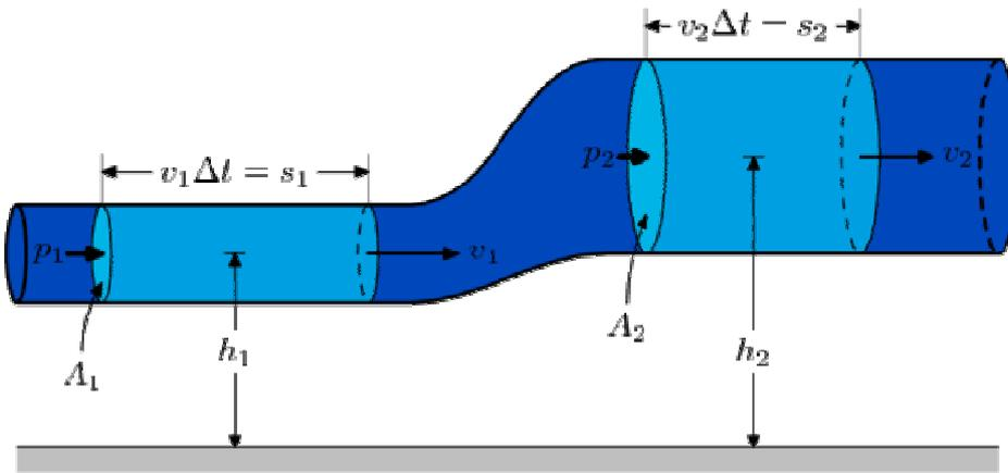
L'équation de Bernoulli pour les fluides incompressibles peut être démontrée, soit, par application du principe de conservation de l'énergie le long d'une ligne de courant, en négligeant les effets thermiques, de viscosité, de compressibilité, soit, à l'aide de l'équation d'Euler.
