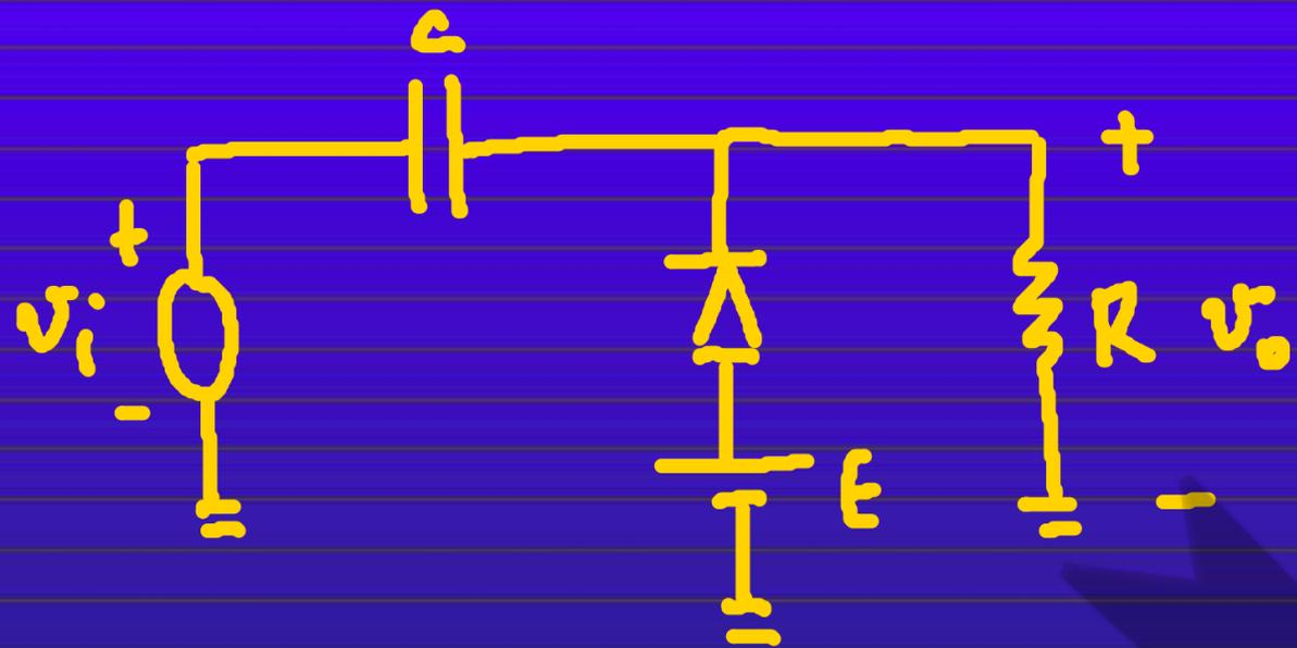
pendant l'alternance (-) la capacité se charge immédiatement et le circuit
