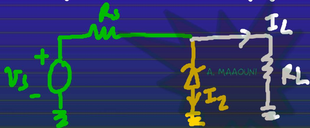
Une tension  $V_{s\min}$  engendre un courant minimal dans la diode ( $I_{Z\min}$ ) pour un courant max dans la charge.
