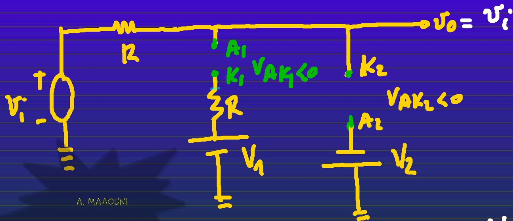
$$V_{AK_1} = V_{A_1} - V_{K_1} = v_i - v_1 < 0 \quad \text{soit} \quad v_i < v_1$$
