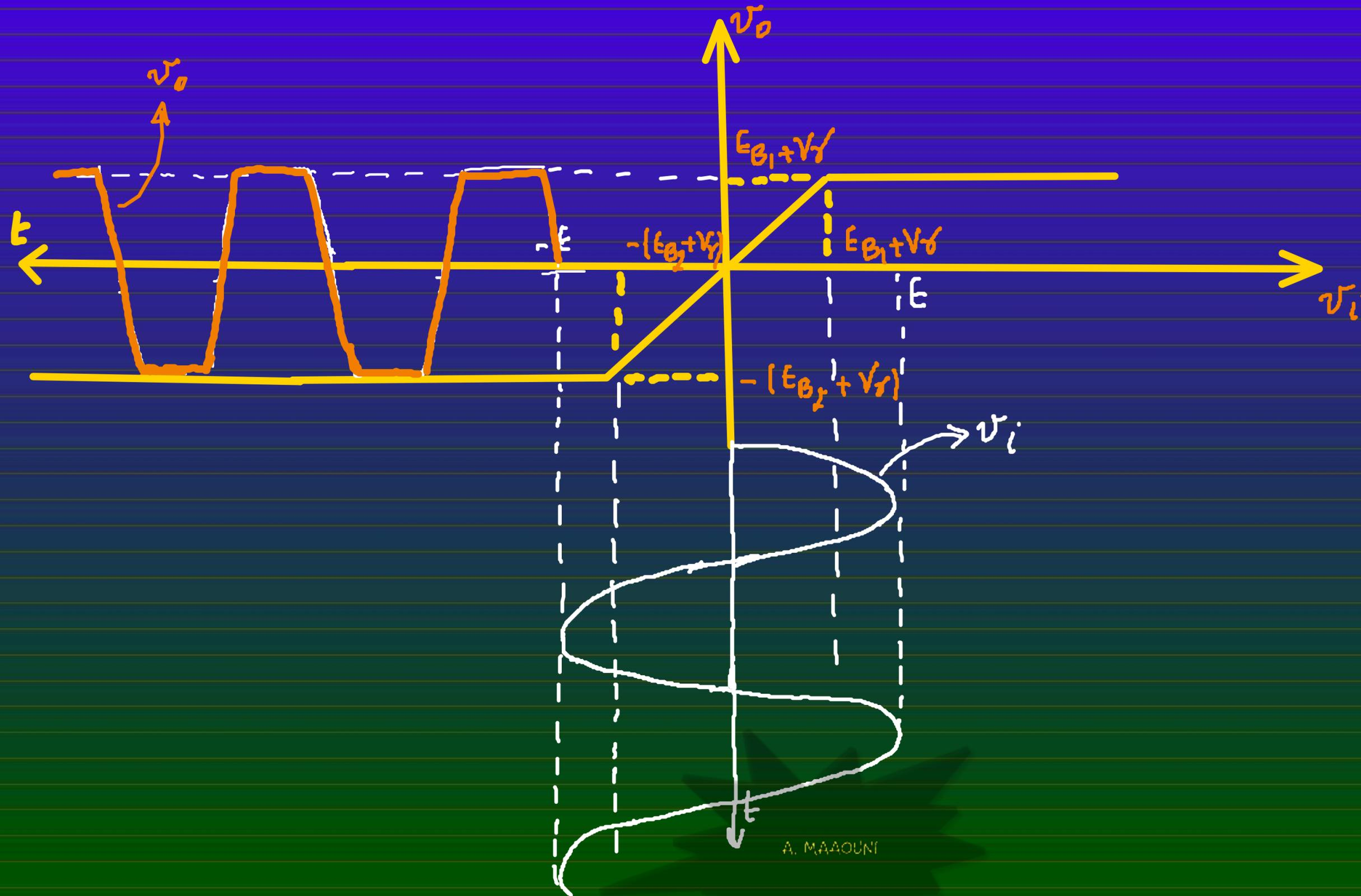
fig 3a: Les deux diodes sont supposées idéales.
