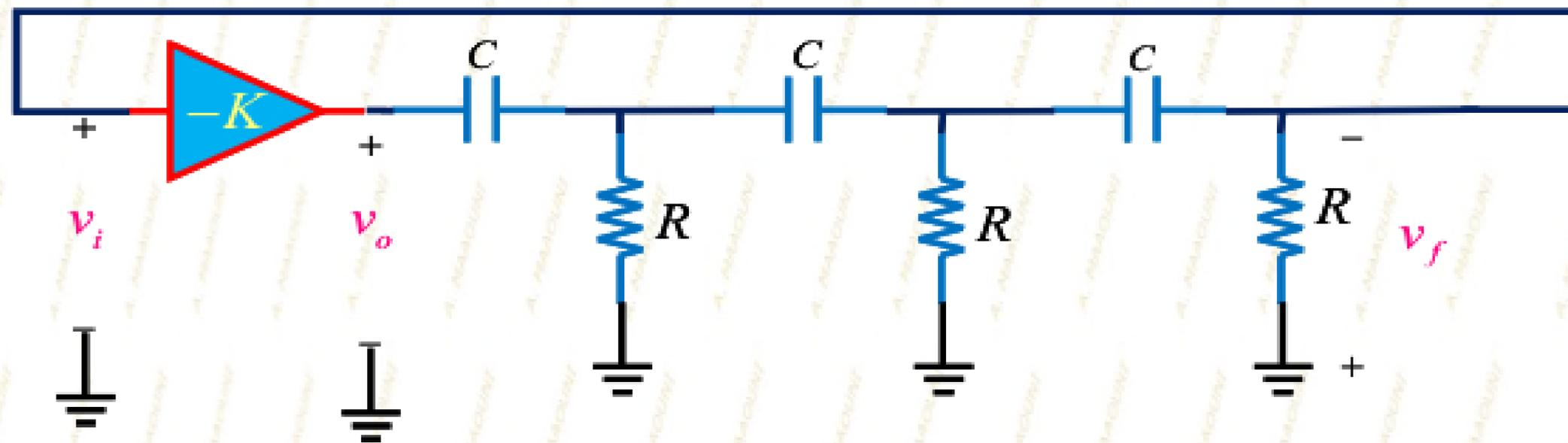
La résistance d'entrée  $R_i$  de l'amplificateur de gain  $-K$  est telle que  $R_i || R \cong R$
