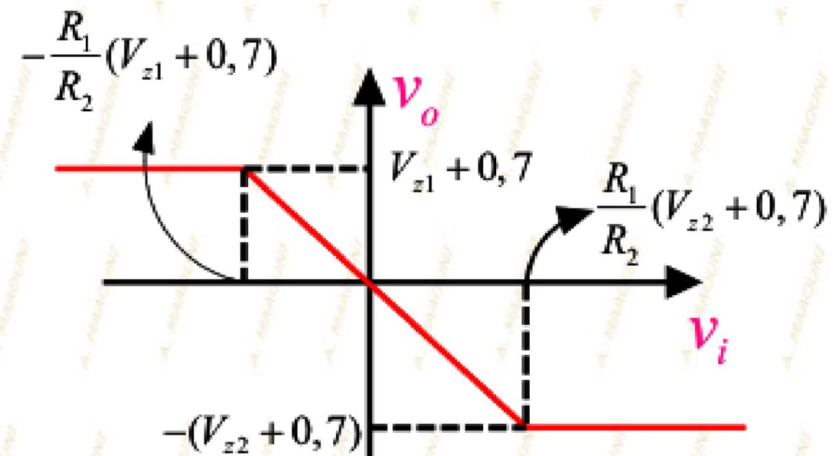
Dans cette configuration de limiteur, le gain  $v_o/v_i$  passe de  $A_{v1}$  à  $A_{v2}$
