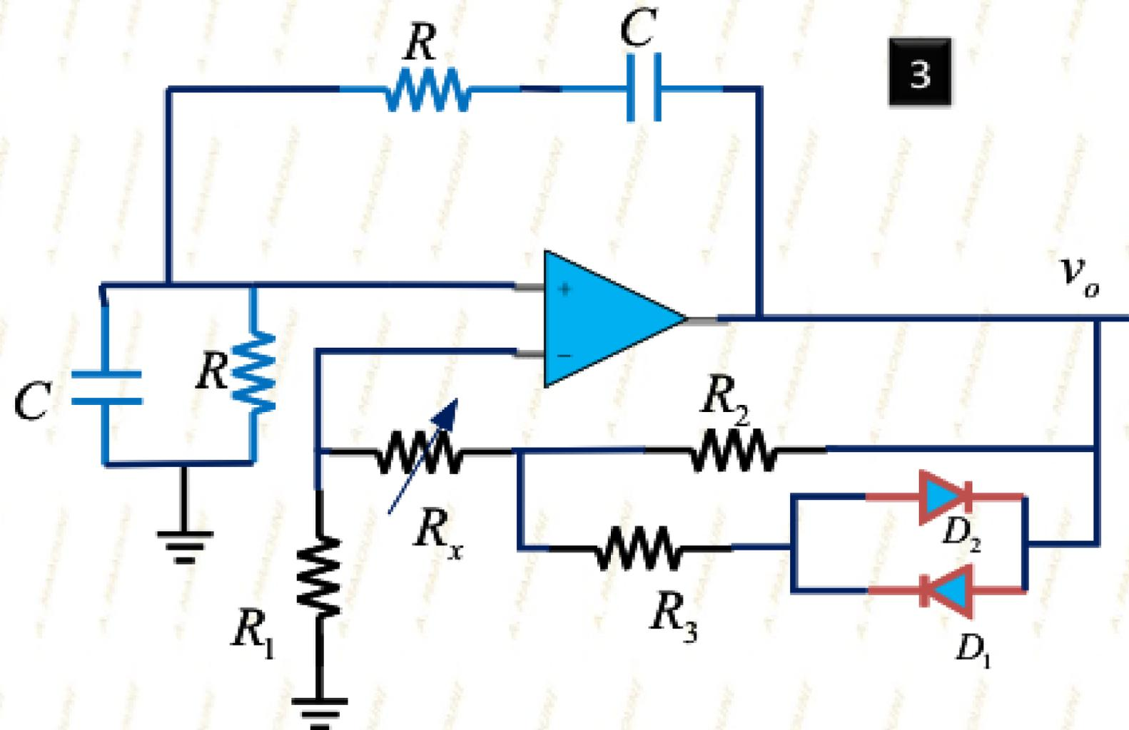
Lorsque les diodes sont 'OFF' pour la configuration 1, le gain est  $1 + R_2/R_1$  et quand elles sont 'ON', le gain devient  $1 + R_2//R_3/R_1$ . La condition d'amorçage des oscillations requière un gain supérieur à 3 (tout en étant très proche), soit :
