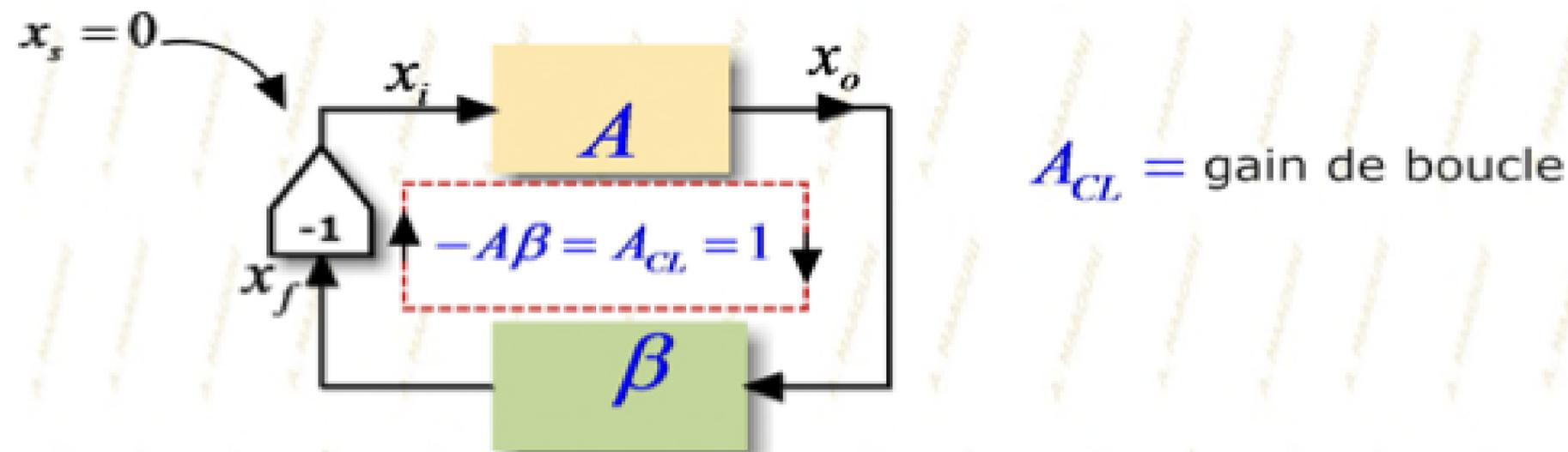
En général, le gain de l'amplificateur  $A$  est indépendant de la fréquence (positif ou négatif). La fréquence  $\omega_o$  est fixée par la condition de phase qui se traduit par :
