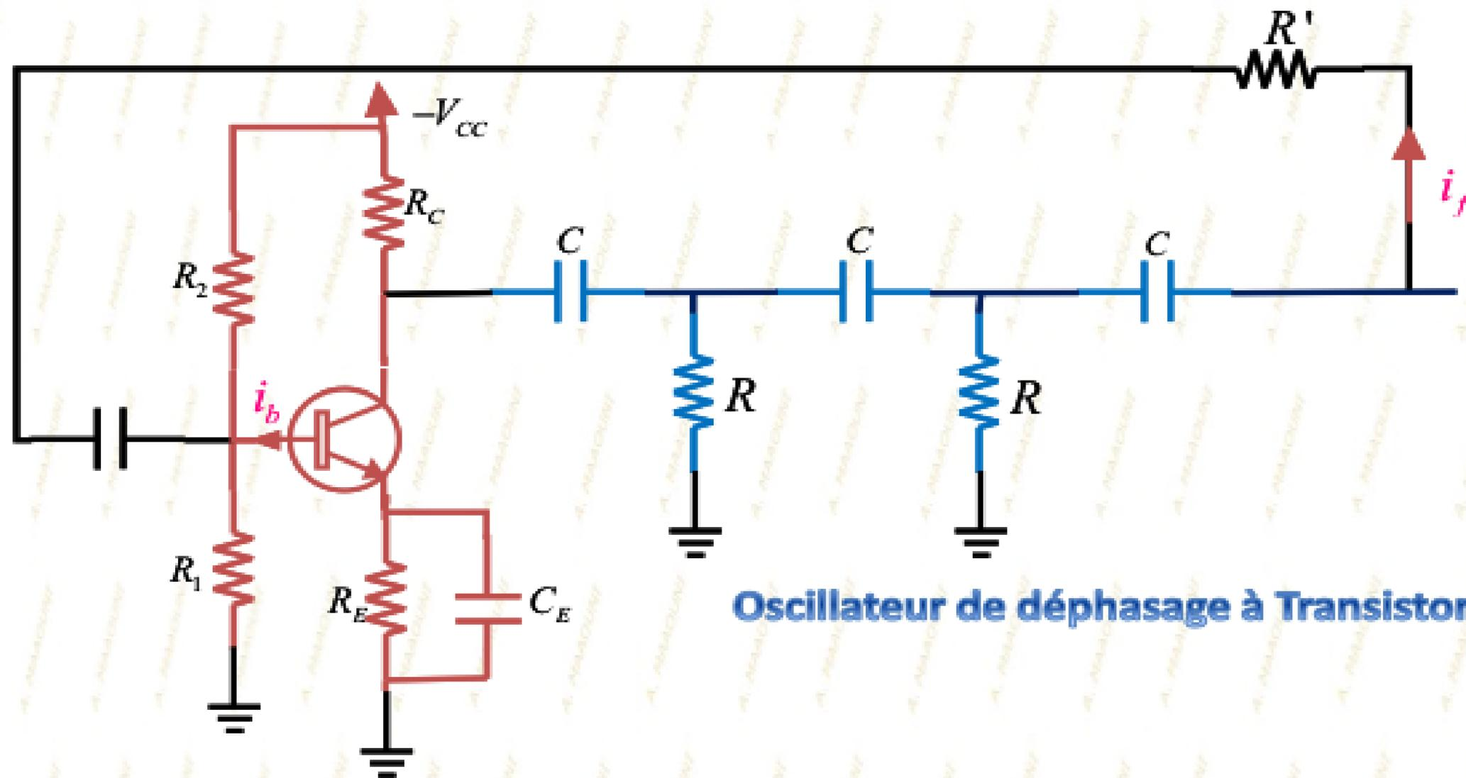
Oscillateur de déphasage à Transistor bipolaire
