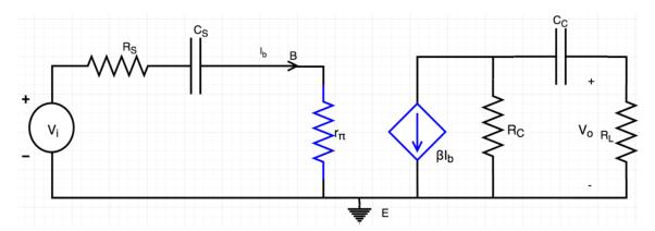
Désignons par  $I_L(j\omega)$  le courant qui traverse la charge  $R_L$  du collecter vers l'émetteur. On note que  $I_L(j\omega)$  désigne le phaseur en régime sinusoidal permanent à la pusisation  $\omega$  associé à  $i_L(t)$ .
