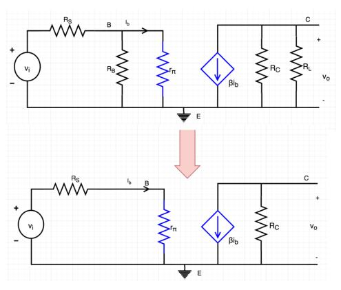
On a :  $v_o=-\beta R_C i_b$  et  $v_i=(R_s+r_\pi)i_b$ . Il s'ensuit que le gain en tension dans la bande de fréquences intermédiaires est donné par :
