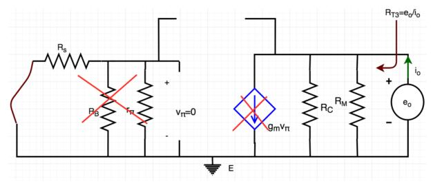
La tension d'entrée est nulle. Il s'ensuit que la source  $g_m v_\pi$  est nulle (circuit-ouvert) et on aura :
