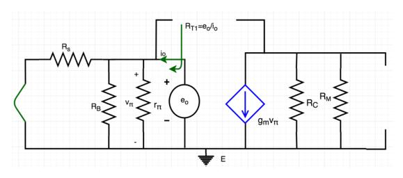
Il est clair que  $R_{T_1}=\frac{e_o}{i_o}=(r_\pi\big||R_B|\big|R_s)$ . La résistance  $R_B=R_1\big||R_2=20k\Omega\big|\big|10k\Omega\cong 6,67k\Omega$
