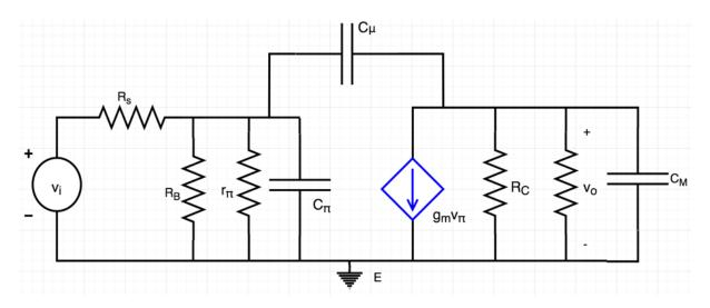
La capacité  $C_M$  est de l'ordre de quelques pF; elle intervient donc en hautes fréquences. Les capacités de couplages et de découplages sont assimilées à des courts circuits dans la bandes des HF.
