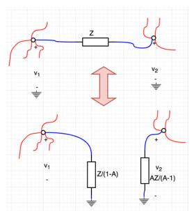
Dans le cas où Z représente l'impédance associée à une capacité et le gain A est réel, on aura l'équivalence décrite dans la figure cicontre.
