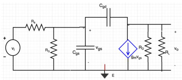
La fréquence haute de l'amplificateur peut être estimée par la méthode des constantes de temps ainsi :
