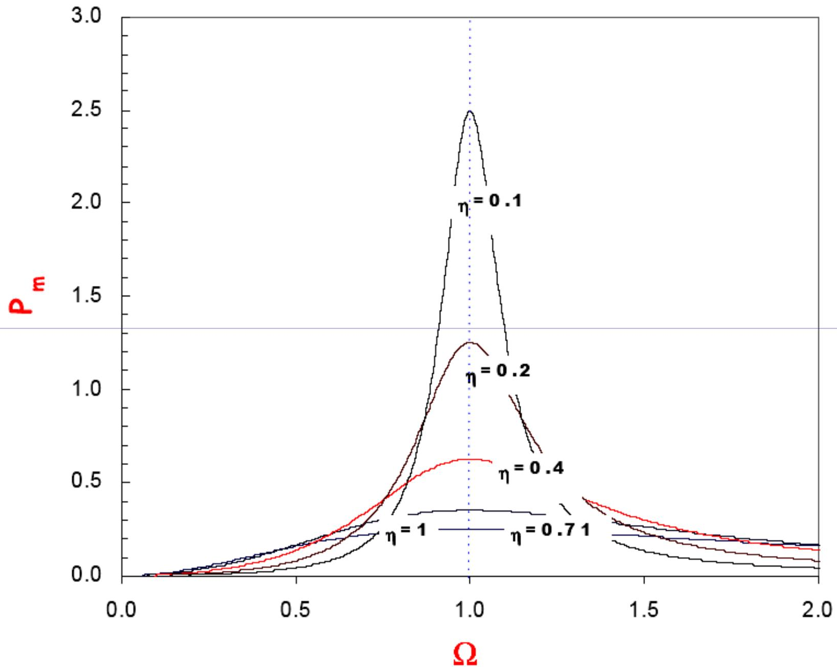
✦ Si on trace la puissance moyenne en fonction de  $\Psi = \ln \Omega$ , on obtient une expression symétrique autour de  $\Psi = 0$ .
