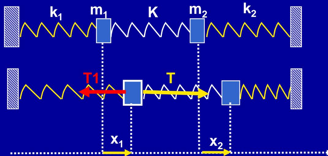
Considérons la masse  $m_1$  : elle est soumise aux tensions  $T_1$  du ressort  $k_1$  et  $T$  due au ressort  $K$ .
