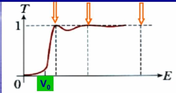
T dépend de la hauteur de barrière  $V_0$ , de sa largeur  $a$  ainsi que de l'énergie  $E$  de la particule incidente.
