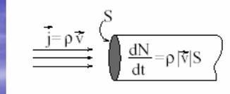
$dN/dt$  est le taux de comptage dans un détecteur de surface  $S$  exposé à un flux de particules dont la densité est  $j = \rho v$ .  $\rho$  étant la densité des particules et  $v$  leur vitesse.
