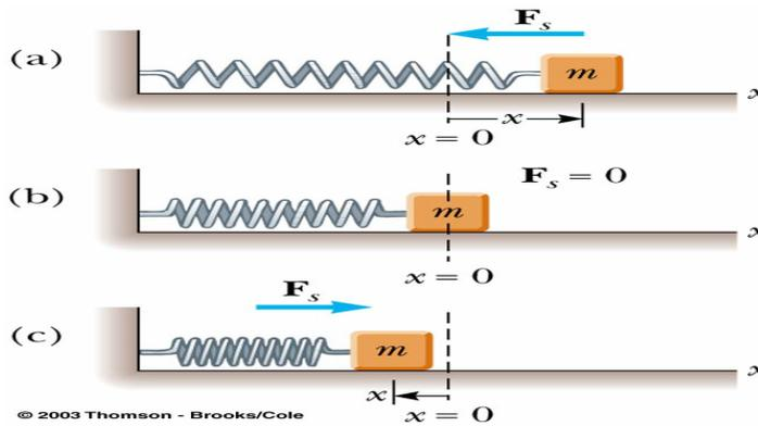
En l'absence de frottement, le poids de  $m$  est compensé par la réaction du support. Il reste la force de rappel du ressort.
