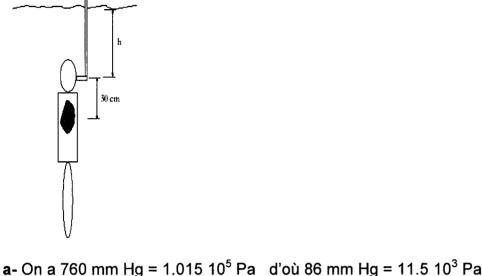
**b-** La variation de pression due à la profondeur h est donnée par :  $\Delta P = \rho_{eau} g h$ . Avec une détente maximale, les poumons sont capables de générer une différence de
