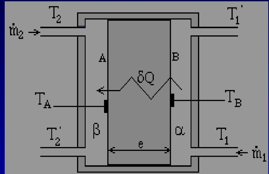
De la relation  $R_\lambda = \delta T / \Phi$ , on déduit la valeur de la résistance thermique  $R_\lambda$  du solide. Connaissant la relation  $R_\lambda(\lambda)$ , on déduit la valeur de  $\lambda$ .
