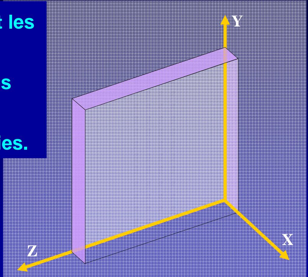
Admettons que les faces  $x = 0$  et  $x = e$  soient respectivement portées aux températures  $T_0$  et  $T_1$  constantes.
