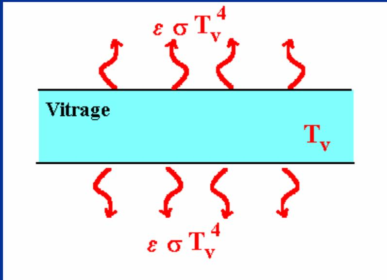
Le vitrage, en équilibre thermique à la température  $T_v$ , émet un rayonnement
