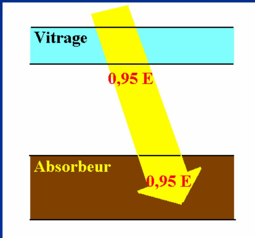
Toute l'énergie transmise par le vitrage est absorbée par l'absorbeur
