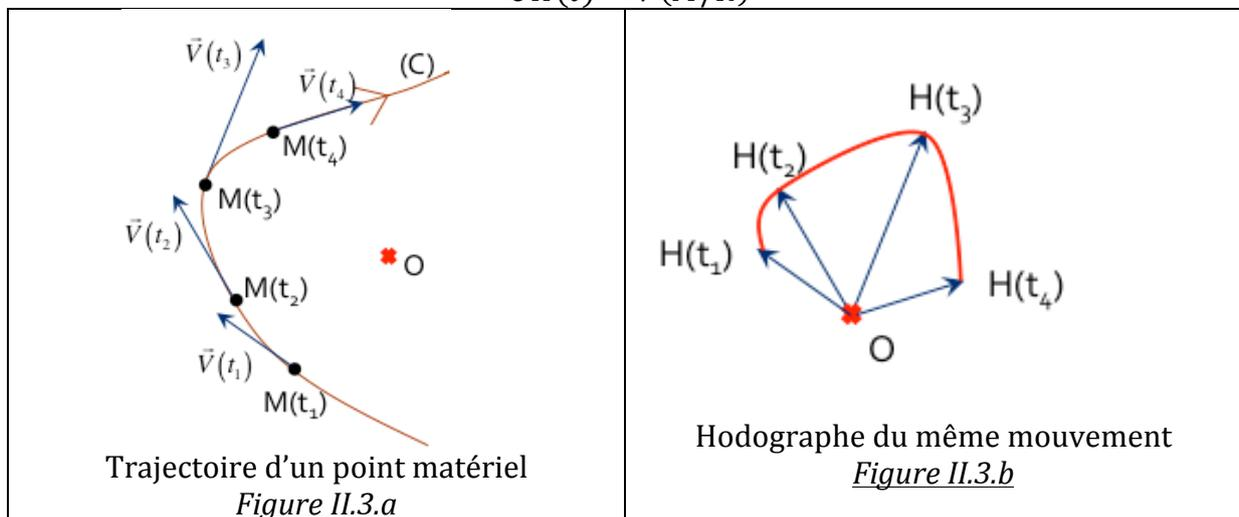
La figure II.3 ci haut, décrit le mouvement d'un point matériel. A gauche la trajectoire est obtenue en reliant les extrémités du vecteur position à chaque instant  $t$ . L'hodographe, à droite, est la courbe décrite par le vecteur vitesse, d'origine  $O$ .
