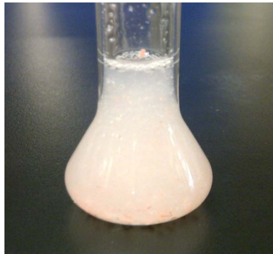
Donepezil Tablet Formulation: Dilution en solvant, agitation mécanique et sonication (d'après la pharmacopée US)
